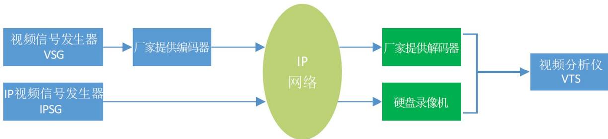
图 6 IP 网络传输系统测试方案
