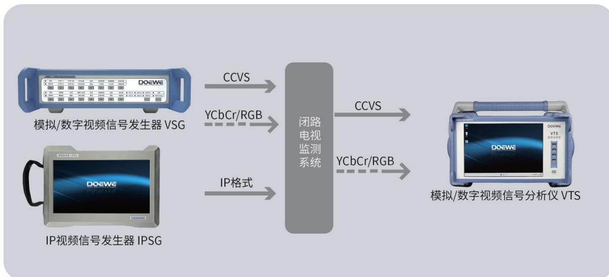
图 4 Vision Eye 测试连接图
