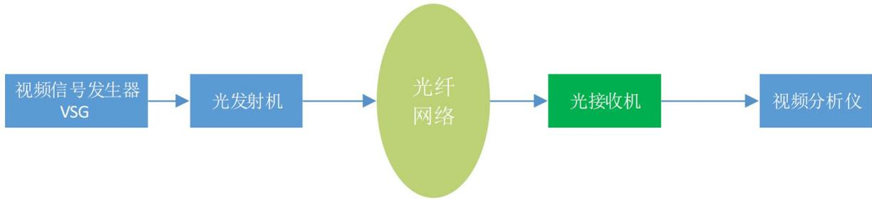
图 5 传统模拟视频传输系统测试方案
