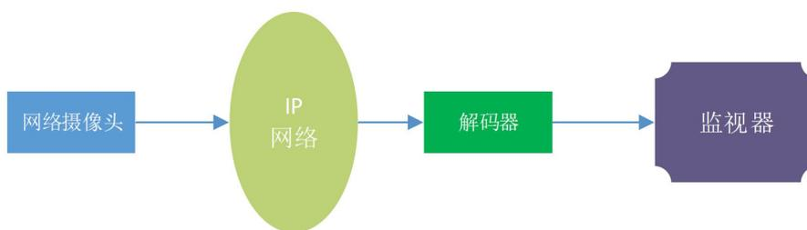
图 3 网络摄像头 IP 传输系统
