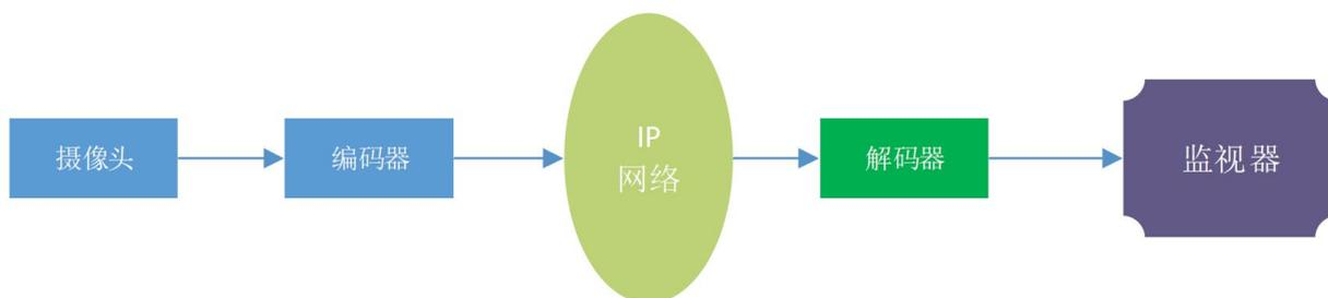
图 2 传统带编码器 IP 传输系统
