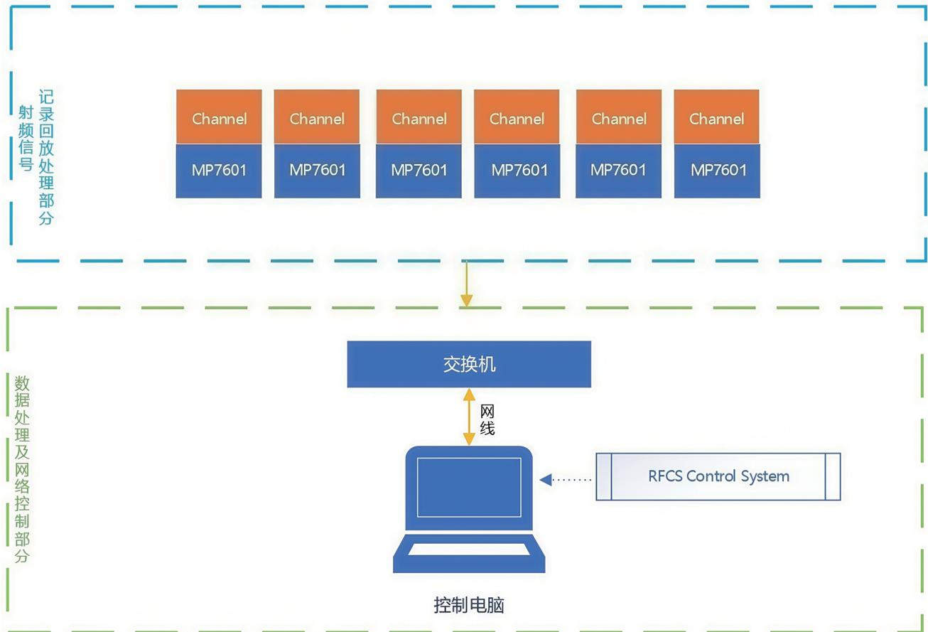
射频信号记录回放处理部分最多由6台专用射频记录回放仪MP7601组成，由此组成6通道。配合系统软件支持定时录制和触发录制功能，支持不同设备设置不同中心频率和采集带宽。采样设备软件可对信号进行增益控制，实现最佳采集精度。MP7601各功能均可以精准达到信号接收、处理方面的需求。整个过程由数据处理及网络控制部分实现自动化，数据处理及网络控制部分由交换机和控制电脑(含总控软件)组成。通过操作总控软件可对射频信号记录回放处理部分的所有MP7601设备进行控制，从而自动化的实现对特定射频电磁环境的录制、回放等功能以及实现整体系统的控制调度。同时支持查看任务记录和生成报告，以供后续对数据进行分析测试。
