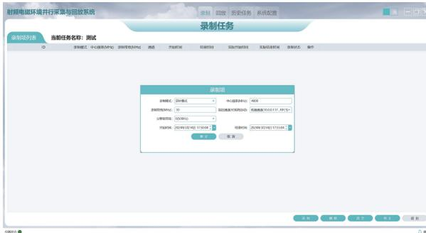
在录制功能界面中新增录制任务，支持设置录制模式、中心频率、录制带宽、分辨率带宽、录制通道、录制开始时间以及录制结束时间。
