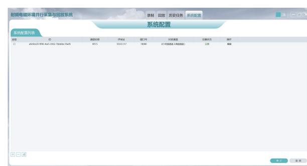
在系统配置功能中添加或使用配置信息，可以调整并展示通道名称、IP地址、端口号以及对应的物理通道，配置应用完毕后可查看当前的连接状态是否正常。
