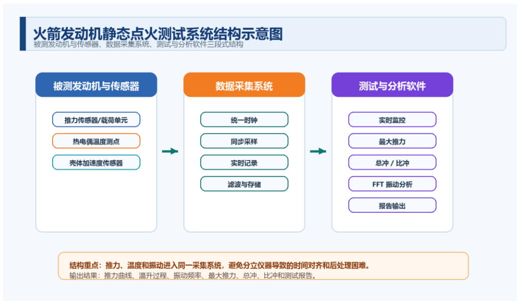
图 2 火箭发动机静态点火测试系统结构示意图
