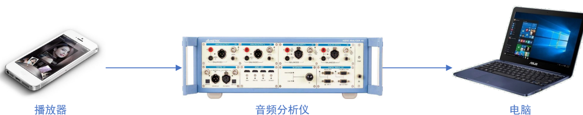
图 5 EN50332-2（播放器）测试连接图
