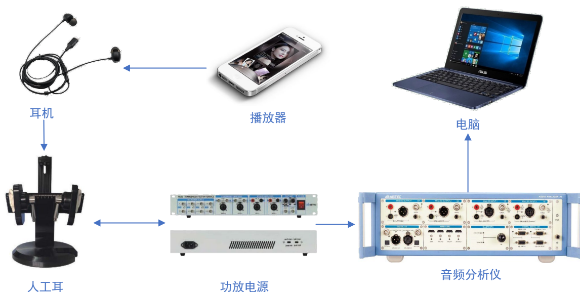
图 4 EN50332-1 测试连接图
