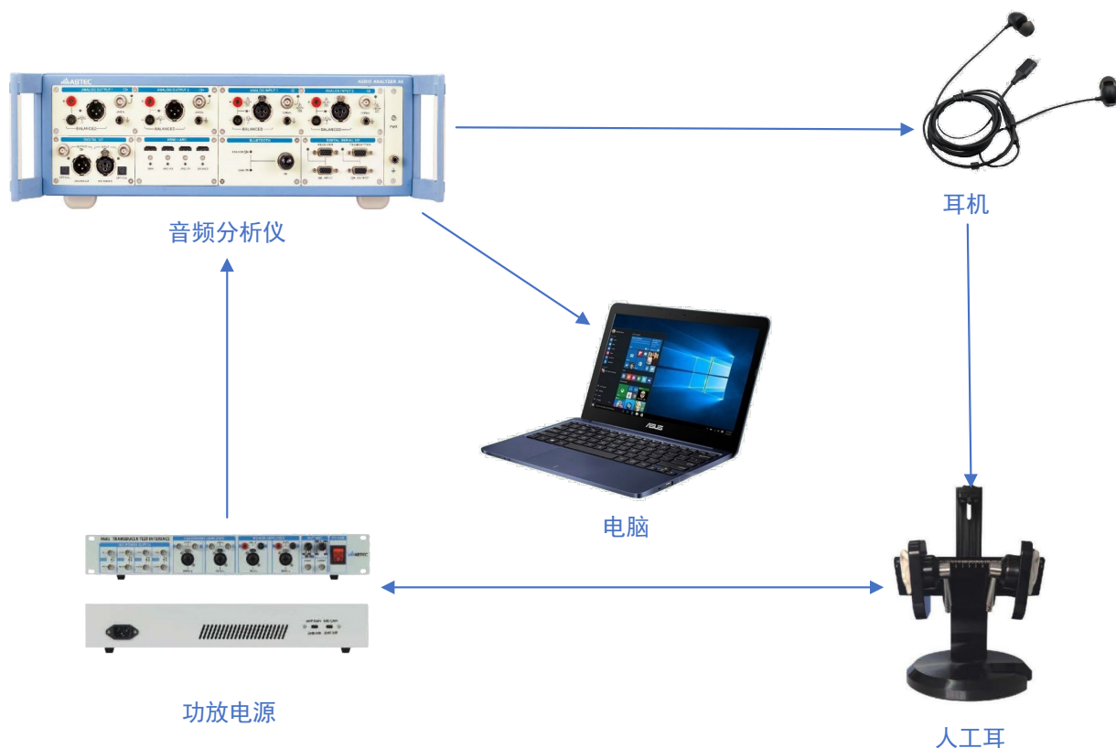
图 6 EN50332-2（耳机）测试连接图
